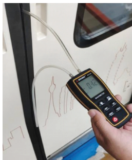
图1 车辆内外压差测试方法
