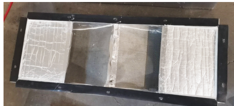
图8 导流消声结构设计实物图
