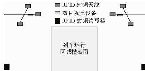
图 3 单股道施工区域端头和端尾监测设备安装示意图
