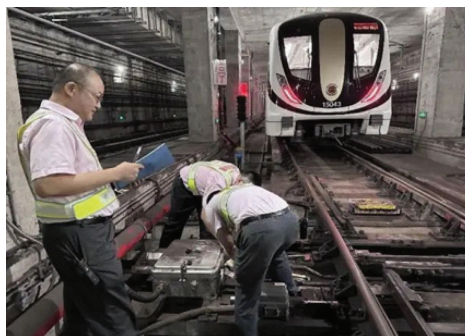
图2 三开道岔故障演练现场照片
