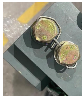
图 8 钢丝串联防松实景图
