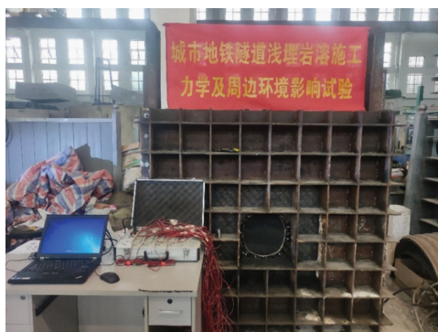
图 3 隧道开挖试验模型箱照片
