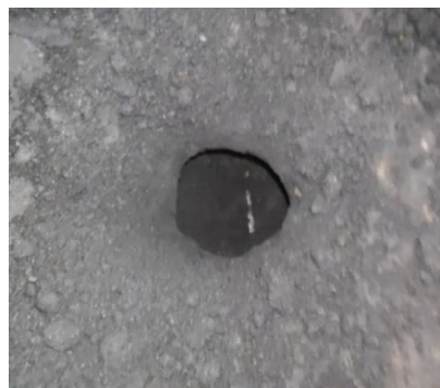
b) 模型围岩中形成的溶洞
