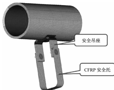
b) 换为 CFRP 安全托的模型
