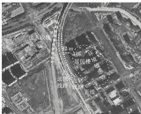
图1 深圳某地铁线路噪声异常段与环境敏感点的线位关系
