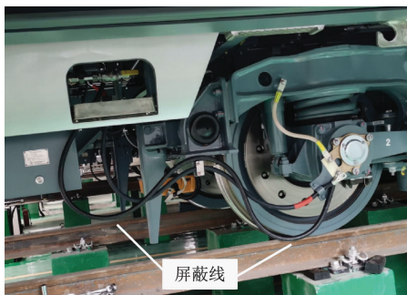
图 6 接地回流线缆更换为屏蔽线
