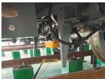
a) BTM 下方区域放置环形干扰天线
