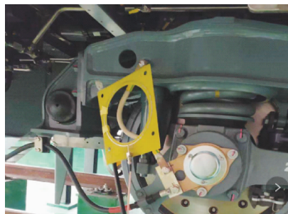
a) 转向架构架连接线缆处放置环形干扰天线
