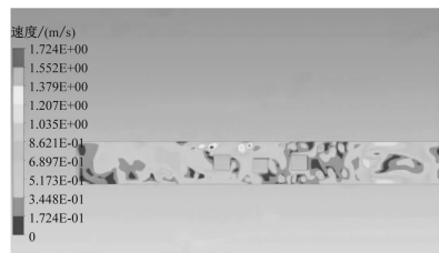
d) 方案一站台气流速度场分布云图(距离中板 1.65 m)
