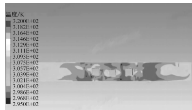
h) 方案三站台气流温度场分布云图(距离中板 1.65 m)
