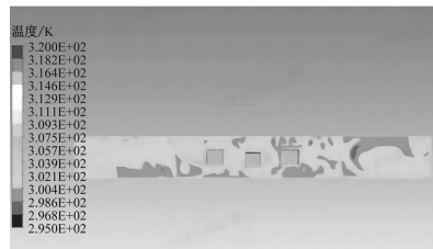
d) 方案一站台气流温度场分布云图(距离中板 1.65 m)
