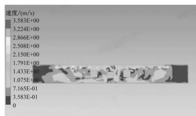
b) 原方案站台气流速度场分布云图(距离中板 1.65 m)
