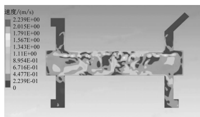
a) 原方案站厅气流速度场分布云图(距离中板 1.65 m)
