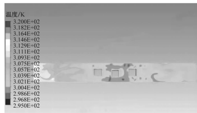
f) 方案二站台气流温度场分布云图(距离底板 1.65 m)
