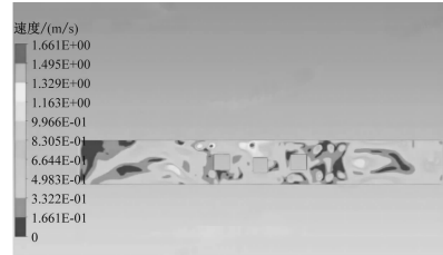
h) 方案三站台气流速度场分布云图(距离中板 1.65 m)
