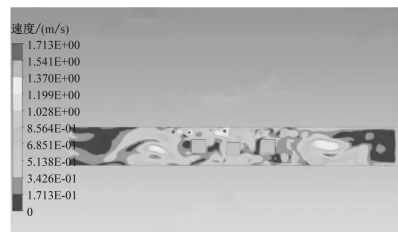
f) 方案二站台气流速度场分布云图(距离中板 1.65 m)
