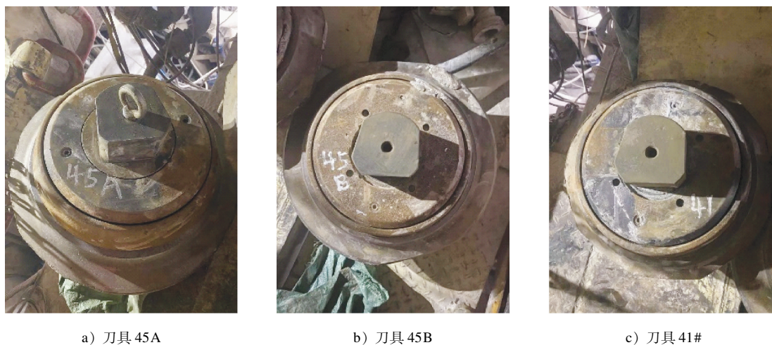
图 3 刀具磨损情况
