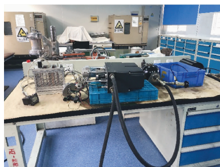
图 6 液压制动力控制试验台
