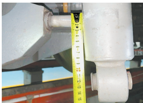
图1 减振器安装螺栓松脱故障照片
