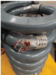
b) 在中间工作圈安装应变片
