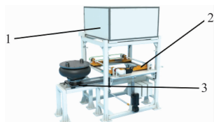
注:1—双轴拧紧系统;2—扣环夹紧机构;3—自动输送及定位装置。
