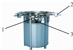
注:1—上推杆机构;2—导轨连杆机构;3—下拉气缸。
