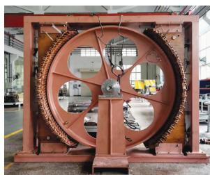
b) 圆弧形 LIM 样机图
