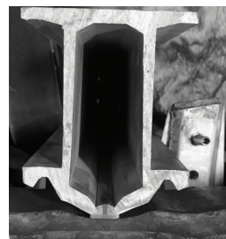
图 8 接触线与碳滑板接触剖面图
