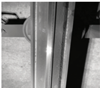
图2 接触线出现亮铜色实物图
