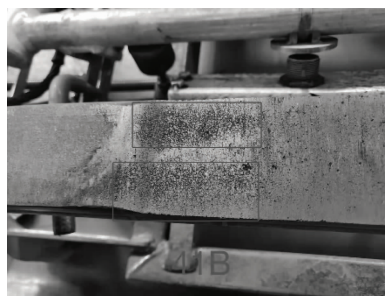
图6 碳膜不完整时的碳滑板表面状态(碳膜不完整)
