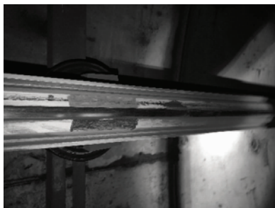
图 7 接触线表面状态(碳膜完整)
