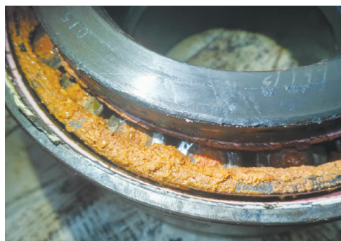
图3 轴承内乳化的油脂
