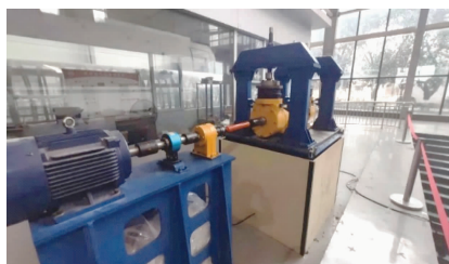
图 5 高速列车轴箱轴承试验台
