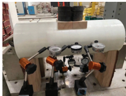
图 6 纵向刚度有效率试验实景图
