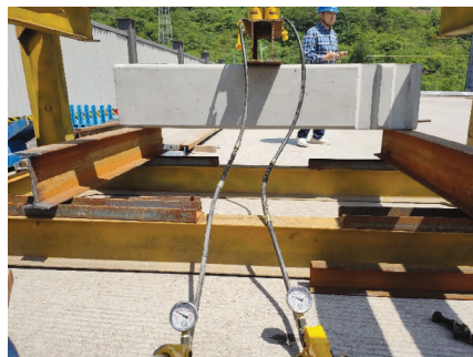
图 6 预制立柱抗弯试验实景图
