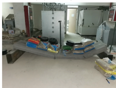
b) 平面外抗弯破坏试验
