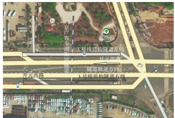
图2 下穿段平面位置关系示意图
