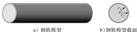
注: r_1 为等效圆形导体半径; r_2 为添加涂层后的总半径。
