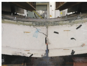
图 25 负弯矩作用下接头破坏照片 Fig. 25 Photo of joint damages under negative bending moment
