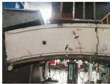
图 13 正弯矩作用下接头破坏照片
