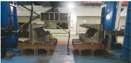
图6 复合腔体加固的盾构隧道管片纵缝接头试验加载系统
