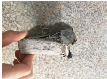
图 10 抗压试验复合腔体破坏照片
