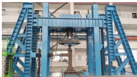
图3 接头试验加载系统
