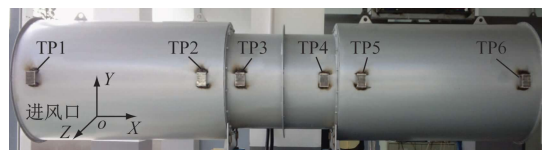
图3 风机本体传感器安装图
