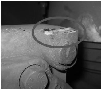
图2 断裂的轴箱吊耳
