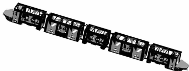
图 6 整车侧墙板安装有限元模型
