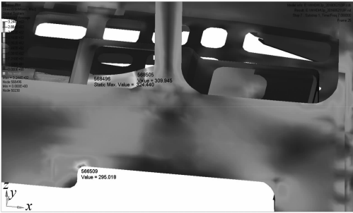
图 3 车体静强度计算云图
