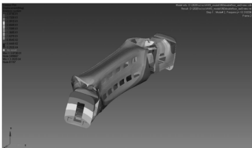
图12 车辆整备状态下的模态位移分布云图
