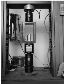
图 1 实验室范围内螺栓轴向力测量装置图
