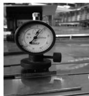
图 4 凹痕深度检测图
