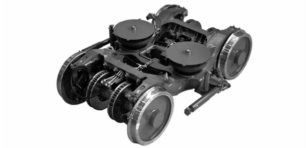
图 8 西门子 SF7000 型拖车转向架
