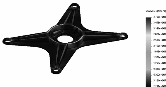
图6 CRTSⅢ型轨道板关键部件回转定子应力云图
