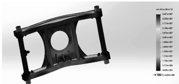
图8 轨道板关键部件连接框架应力云图
