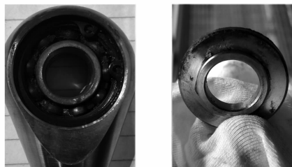
a) 电蚀损伤的轴承 b) 电蚀损伤的端盖
