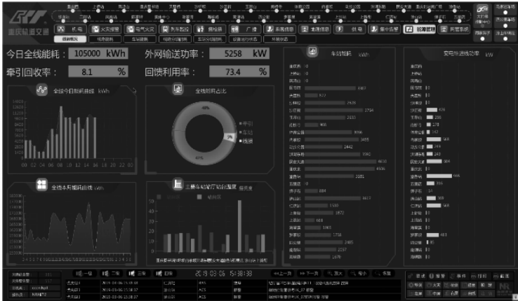
图 2 重庆环线基于 PSCADA 数据的能源管理系统界面
