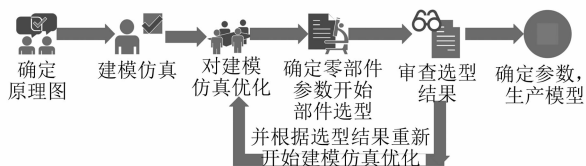
图3 气制动控制单元部件设计及选型流程图
