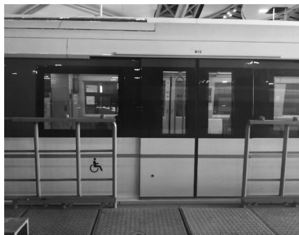
图 9 北京磁浮 S1 线疏散方式——站内空车连接疏散平台端部与站台
