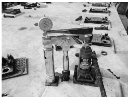
图 10 螺栓抗拔力测试照片
