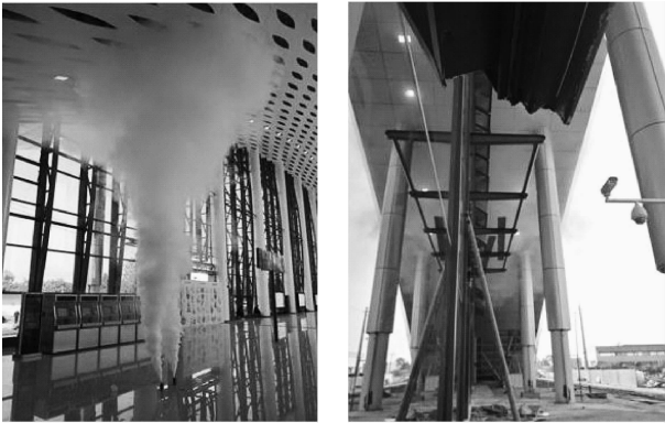
图10 地面厅冷烟测试现场图
