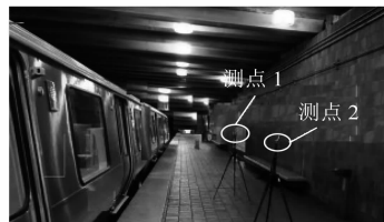
图 2 车辆静置在站台的噪声测试测点布置
