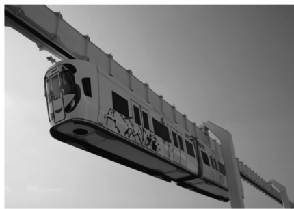
图 2 对称式开口箱梁胶轮悬挂列车
