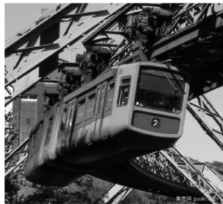
图 1 非对称式“工”字梁钢轮悬挂列车
