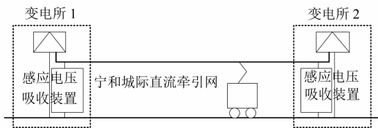
图 16 感应电压吸收装置安装示意图
