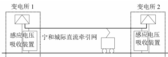
图 16 感应电压吸收装置安装示意图
