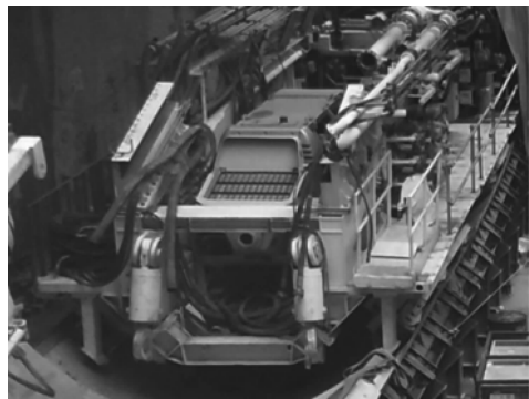
图 1 混凝土拖泵安装在盾构机 1 号台车内
