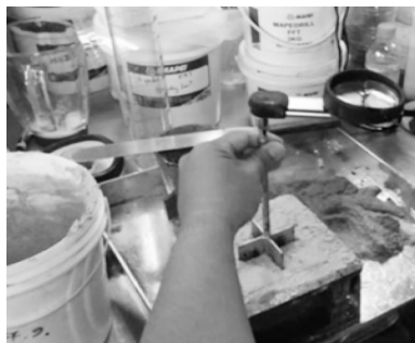
图 4 叶片剪切试验
