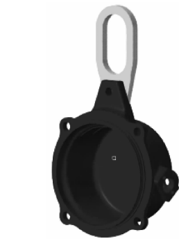
图5 轴箱-吊耳三维模型图
