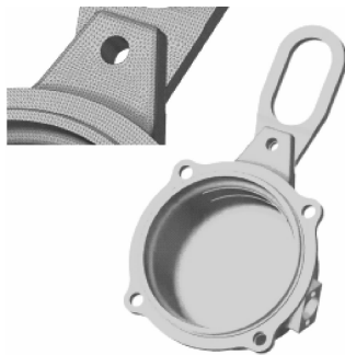
图6 轴箱-吊耳有限元模型图
