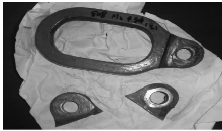
图 1 轴箱吊耳断裂实物照片
