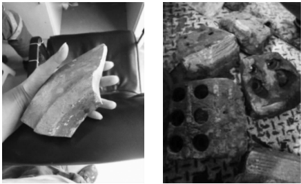
a) 滚刀刀圈 b) 掉落刮刀 图 1 开仓打捞出 的脱落刀具及石块
