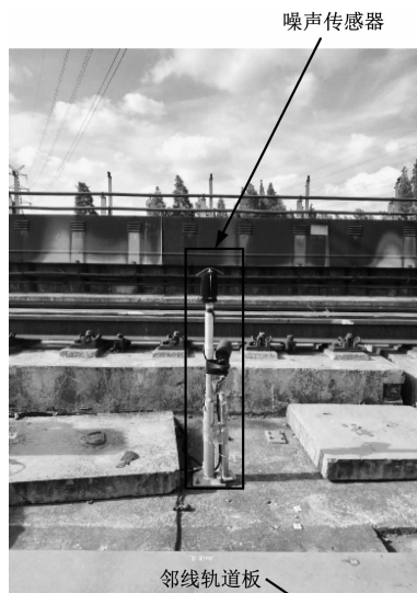
图 8 传感器安装与系统调试
