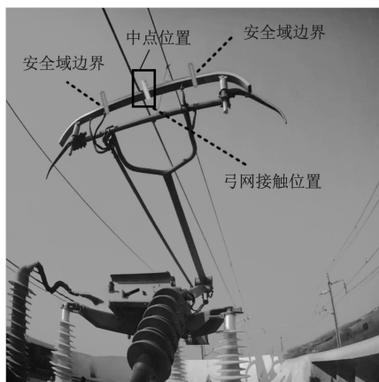
图5 受电弓的视频动态监测效果
