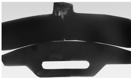
图5 新闸瓦与新轮踏面样板的配合示意图
